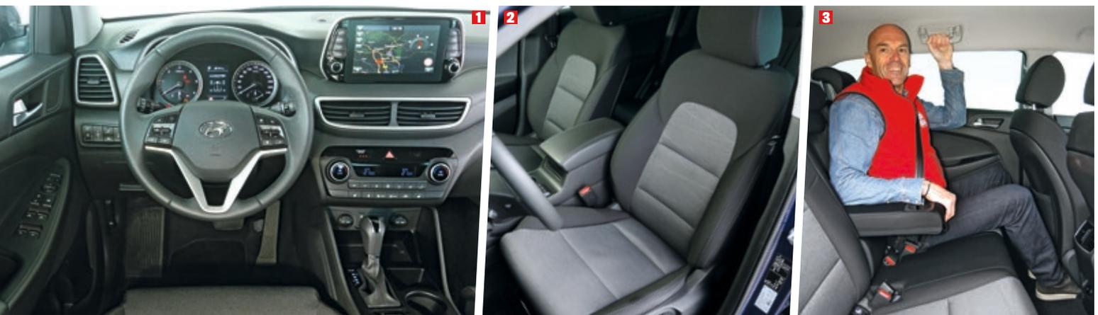
**1** Armaturenräger mit aufgesetztem 8-Zoll-Berührbildschirm. **2** Vorderer Sitz auf 690 mm Höhe über der Fahrbahn. **3** Ordentlich Knieraum auf der in angenehmer Höhe positionierten Rücksitzbank. **4** Neuer 1,6-Turbodiesel mit 48-Volt-Startergenerator mit 12 kW, gespeist aus einer Lithium-Polymer-Batterie mit 0,44 kWh im Kofferraum. **5** Trotz größter Außenlänge nur durchschnittlicher Laderaum mit hoher Kante. **6** Telefonkopplung serienmäßig
