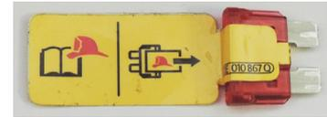
12V-Bordspannung des Fahrzeugs deaktivieren
