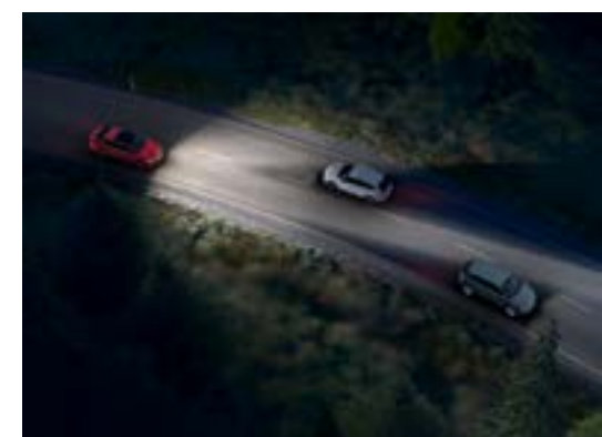
Mehr Sicherheit in dunklen Tageszeiten: der dynamische Fernlichtassistent
