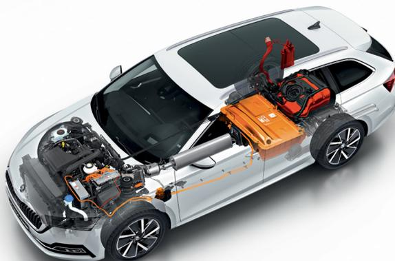
Die Antriebseinheit besteht aus einem Benzin-Verbrennungsmotor, einem Elektromotor und einer Antriebsbatterie.
