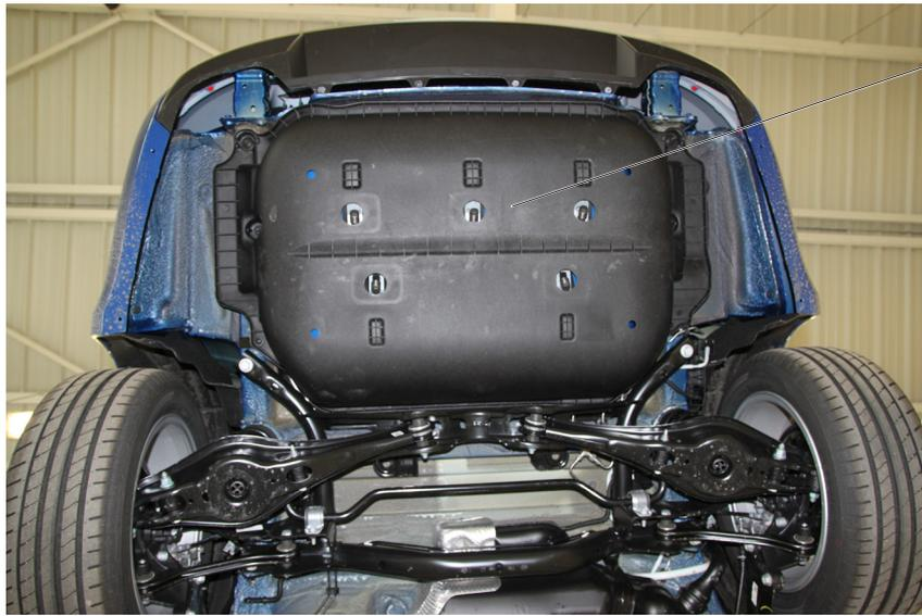
Erdgastanks hinter der Hinterachse
