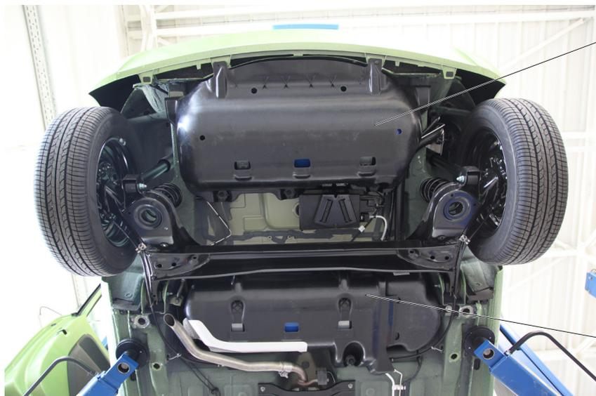
Erdgastank hinter der Hinterachse
