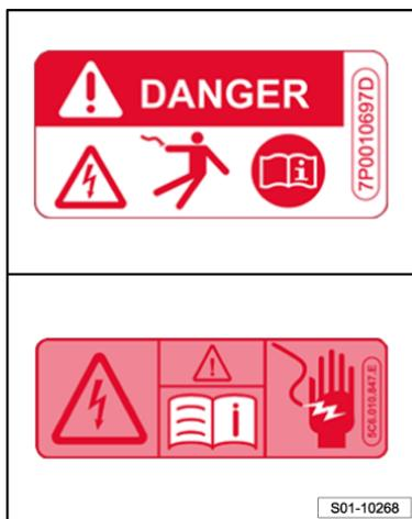
Vom Hochvoltsystem kann bei unsachgemäßer Handhabung eine Gefährdung ausgehen. Deshalb verfügt das Elektrofahrzeug über ein umfassendes Sicherheitskonzept, das alle Bauteile des Hochvoltsystems umfasst, d. h.:
