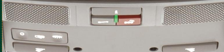
Zur generellen Anforderung von Hilfe bei Schaden, Panne, Unfall, von Leistungen der Mobilitätsgarantie oder allgemeinen Informationen. Das Drei-Tasten-Modul ermöglicht durch Drücken der entsprechenden Taste den direkten Verbindungsauflauf – und das rund um die Uhr.
